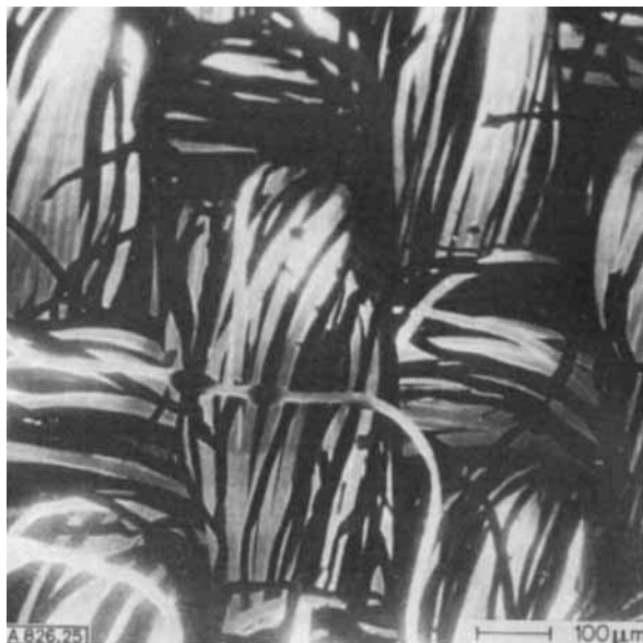
Abb. 25. Baumwolle-Polyester-Mischgewebe nach Waschtest unter Zusatz von Weißtöner. Aufnahme mit Kathodolumineszenz.
