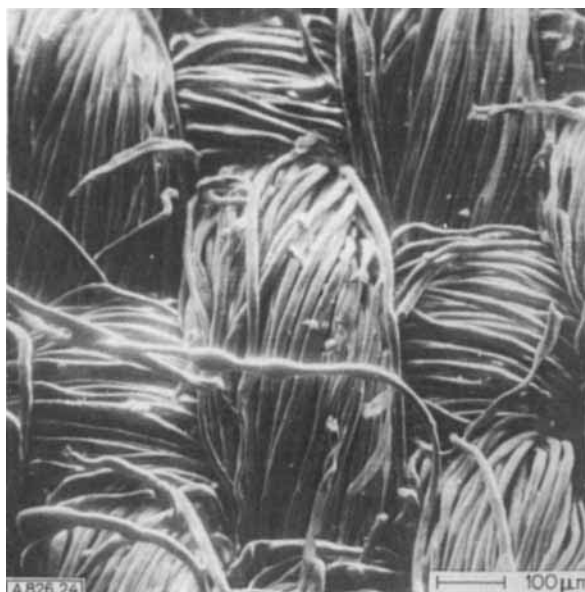
Abb. 24. Baumwolle-Polyester-Mischgewebe nach Waschtest unter Zusatz von Weißtöner. Aufnahme mit Sekundärelektronen.
