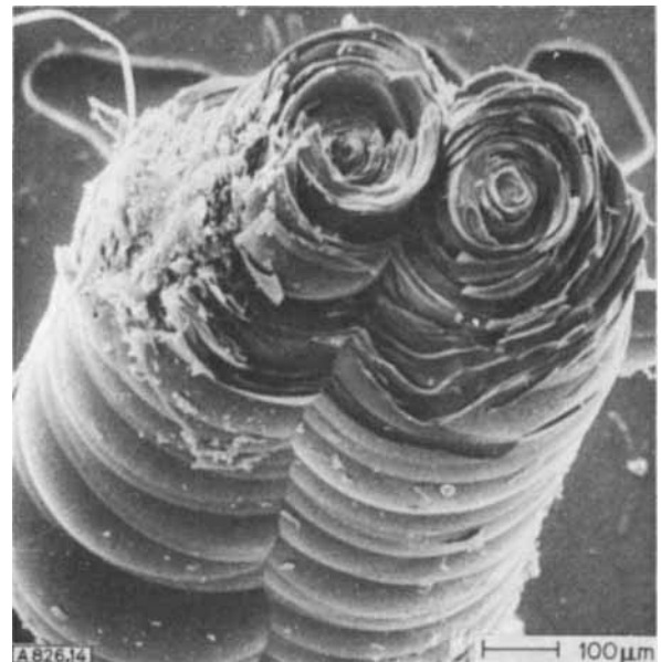
Abb. 14. Kohlenstoffkristall aus einem Pyrolyseofen.
